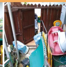
비상구(비상계단) 접근 및 개방에 방해되는 장애물 적치
